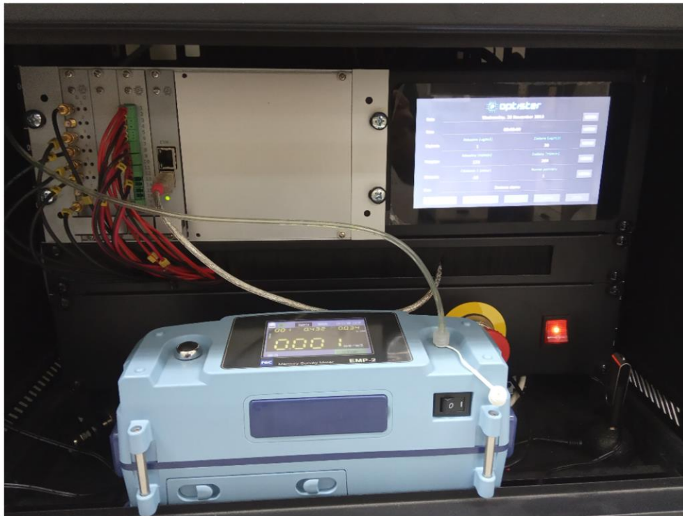
Rysunek 13. Panel sterowania Systemu Badawczego Par Rtęci (SBPR-1) oraz analizator EMP-2.
