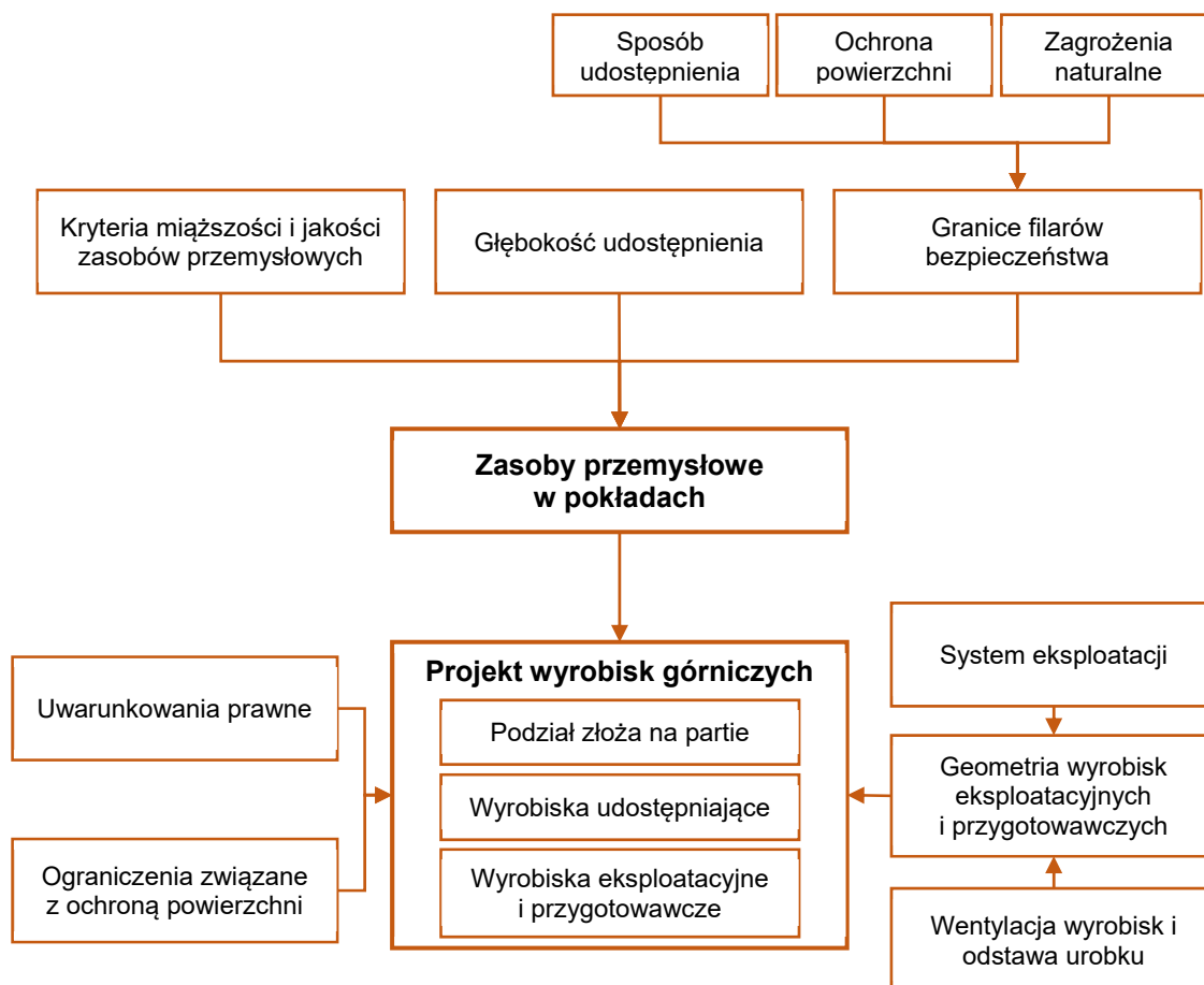
Rys. 6.6. Schemat przyjętej metodyki projektowania wyrobisk górniczych (opracowanie własne)
