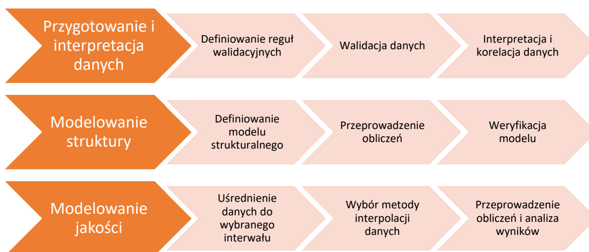
Rys. 6.3. Schemat budowy modelu złoża (opracowanie własne)
