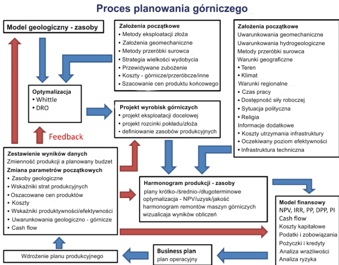
Rys. 4.3. Ogólny schemat procesu planowania produkcji górniczej (Fuykschot 2009)
